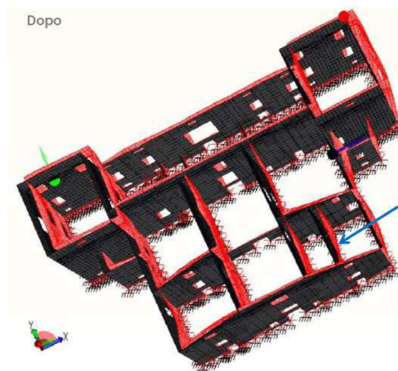
Modellazione dopo gli Interventi: Grande riduzione spostamento muro scala interna e di tutte le altre quantità.
